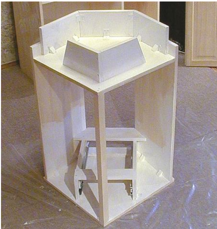
Угловая витрина изнутри. Это нагромождение досточек - опорная рама для выдвигающего ящичка
